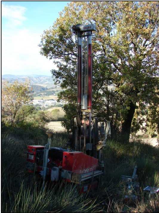
Figura 2.1: Penetrometro sul punto d'indagine n° 1.
