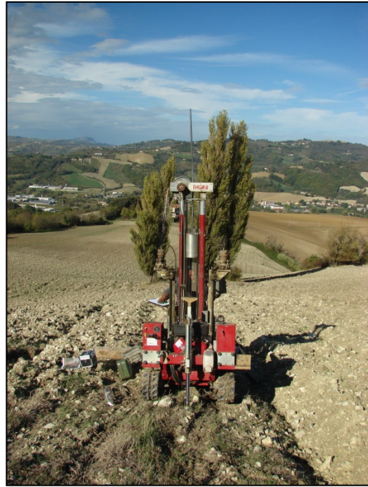
Figura 2.2: Penetrometro sul punto d'indagine n° 2.
