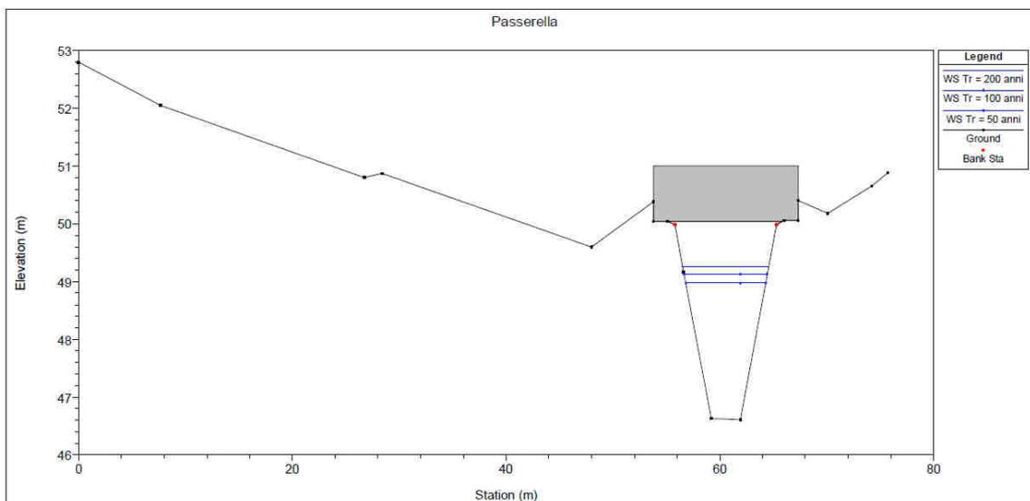
**Figura 3.17 SEZIONE DEL MODELLO IDRAULICO IN PROSSIMITÀ DEL NUOVO MANUFATTO IN CONDIZIONIDI BASSA OFFICIOSITÀ**
