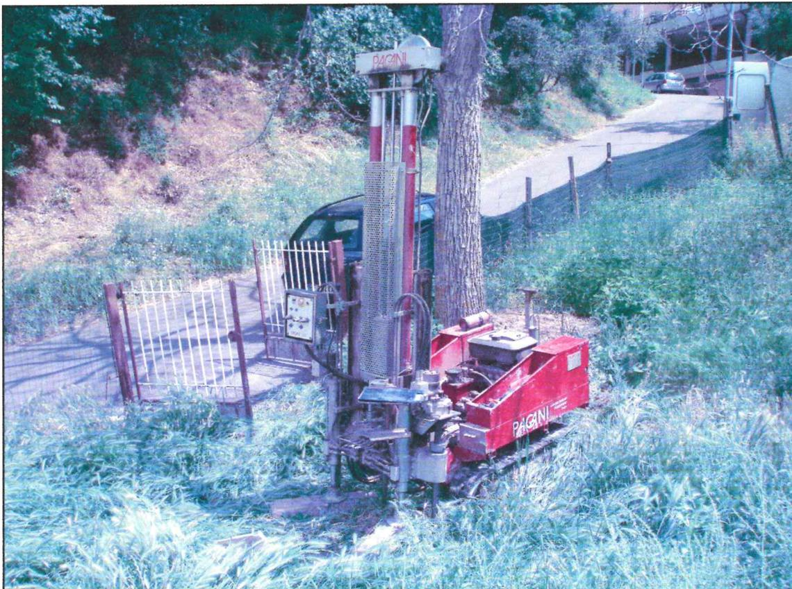
**Figura 6:** Prova penetrometrica CPT3
