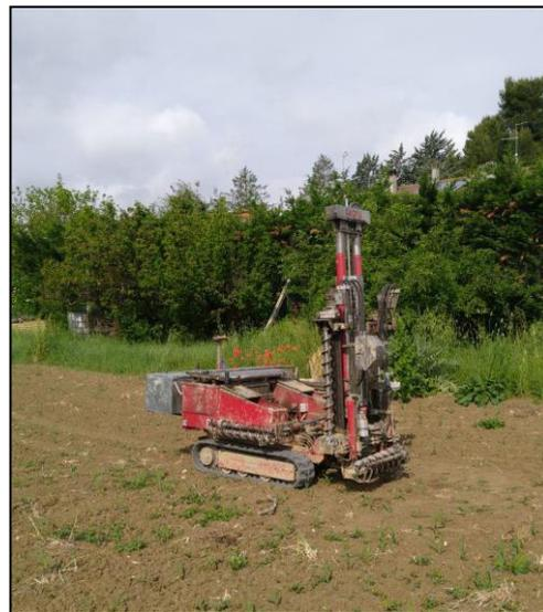
**Figura 8.2.1** – Foto prove penetrometriche CPT1-CPT2
