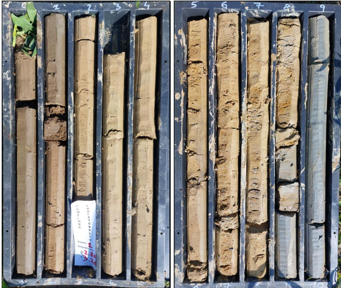
**Figura 8.1.3** – Cassette catalogatrici e carote del Sondaggio S1 (0 – 10.5 m)
